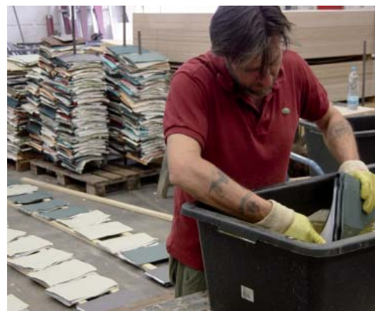
Tauchbad-Imprägnierung von Papier und Pappe – Hier werden Requisiten aufgrund ihrer Menge wie Dekorationen behandelt.
